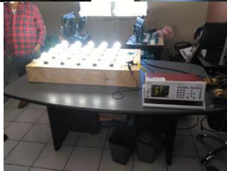
Imágenes 64, 65 y 66. Pruebas de los parámetros eléctricos de los bombillos LED.
