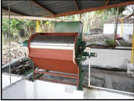
**Figura 3: Tamizador mecánico de aguas mieles**
