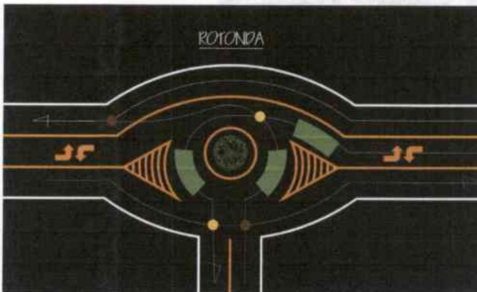
*Imagen 4.0 Puntos de Colisión Intersección 3 y 2 carriles, de 3 salidas.*
