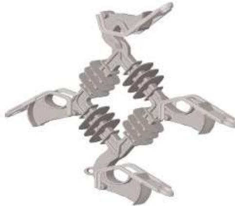
Los espaciadores o separadores serán construidos con la suficiente resistencia mecánica como para soportar a los conductores de fase a intervalos de 30 pies. Sostendrán a los conductores en configuración romboidal. La distancia entre fases será para una tensión del sistema de 34.5kV, como referencia este espaciador su distancia entre conductores no deberá ser menor a 17,75 pulgadas o (0.45m).
