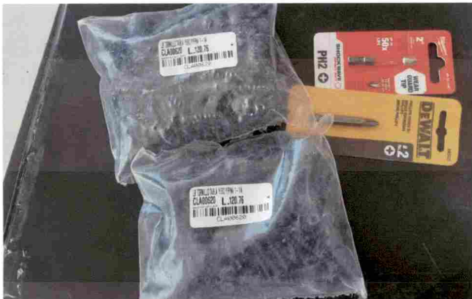
TORNILLOS DE ACERO Y BROCAS PARA CONSTRUCCION DE MOLDURAS EN COLUMNAS DE FACHADA PPAL.
