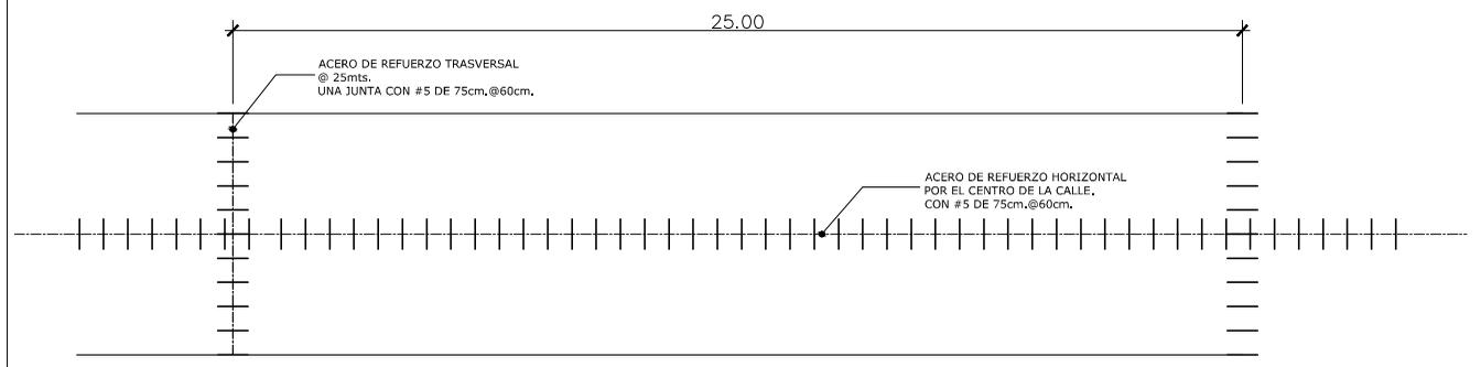
**DETALLE DE SECCION DE ACERO DE REFUERZO**
