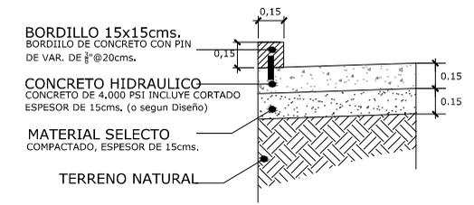
**DETALLE DE BORDILLO DE CONCRETO HIDRAULICO**
