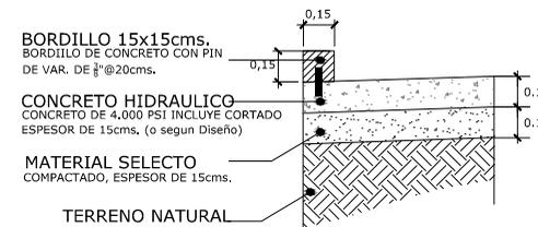
**DETALLE DE BORDILLO DE CONCRETO HIDRAULICO**
