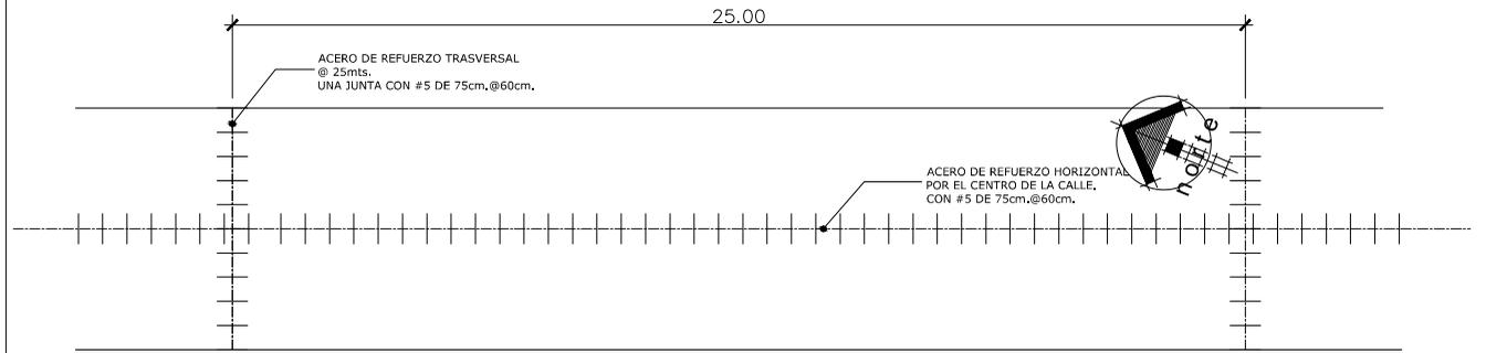
**DETALLE DE SECCION DE ACERO DE REFUERZO**
