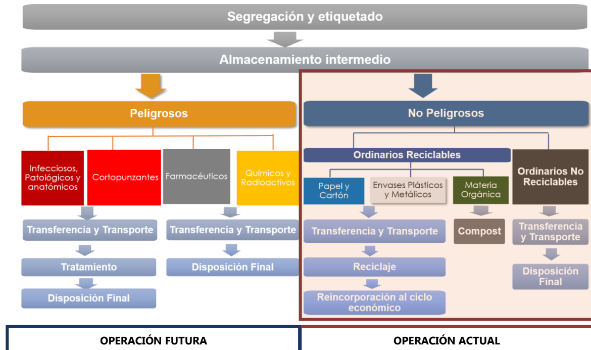
Figura 1. Diagrama del modelo de gestión de residuos sólidos a ser implementado en el Edificio Ciencias de la Salud - UNAH Valle de Sula
