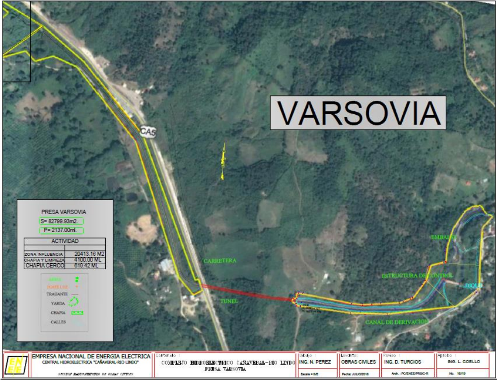
No. 17. Presa y Canal de derivación Varsovia
