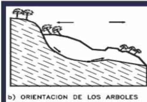
Figura 19. Deslizamiento rotacional.
