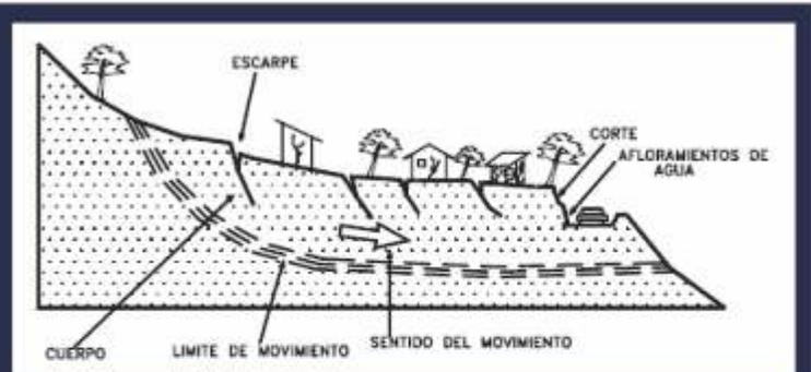
Figura 20. Escarpes, grietas de tensión en viviendas.
