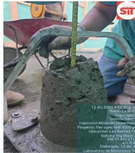
Ensayos al concreto fresco para evaluar su trabajabilidad en laboratorio, y tener una fácil colocación en campo y asegurar la calidad del mismo.
