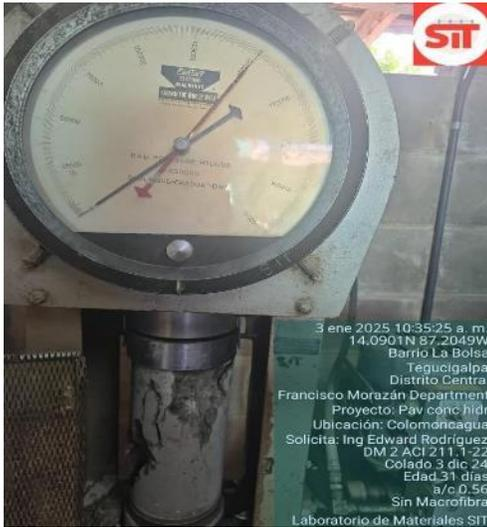
Ensayos para evaluación de resistencias del concreto de diseños de mezclas utilizados en los diferentes proyectos de la institución.
