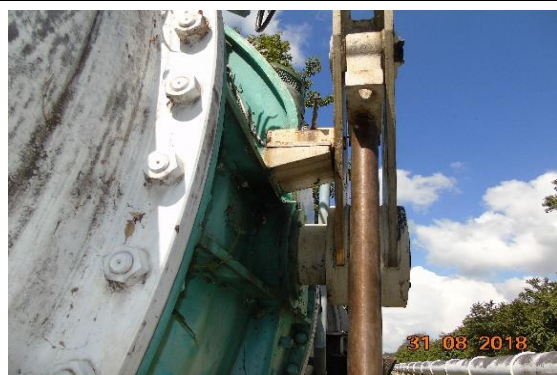
El lápiz señala el empaque del disco de la válvula
