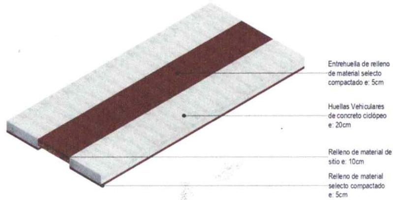
AXONOMÉTRICO HUELLAS DE CONCRETO CICLÓPEO
