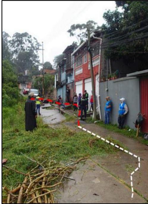
Ilustración 7. Líneas punteadas donde comienza el escarpe del deslizamiento.
