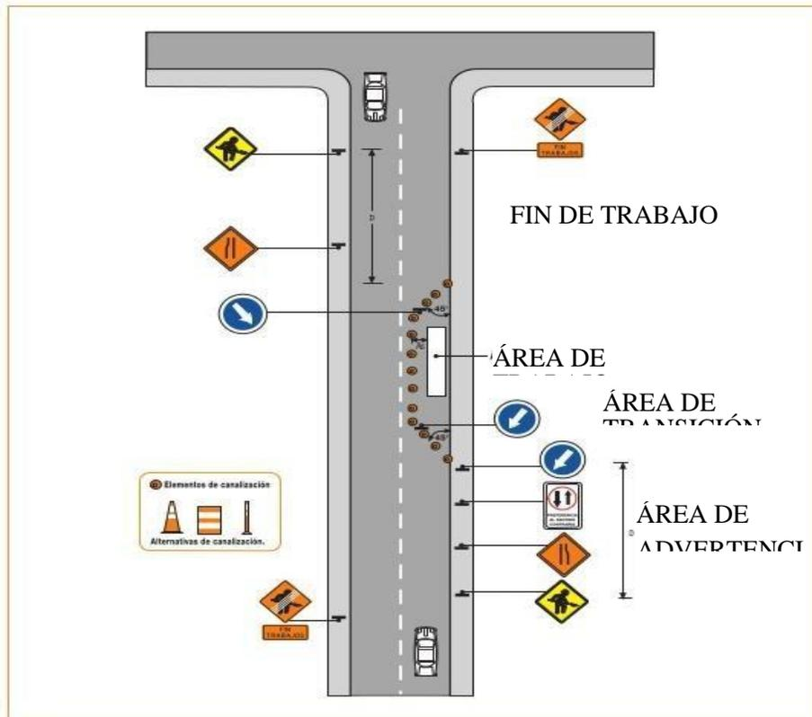
Este esquema se aplica siempre y cuando el flujo bidireccional es menor a 800 vehículos por día, la longitud de seguridad ( $L_s$ ) más la longitud de los trabajos es menor a 75 m y los conductores que se aproximan en ambos sentidos tienen una visibilidad de al menos 100 metros desde el lugar donde se ubica la señal "Trabajos en la Vía".
