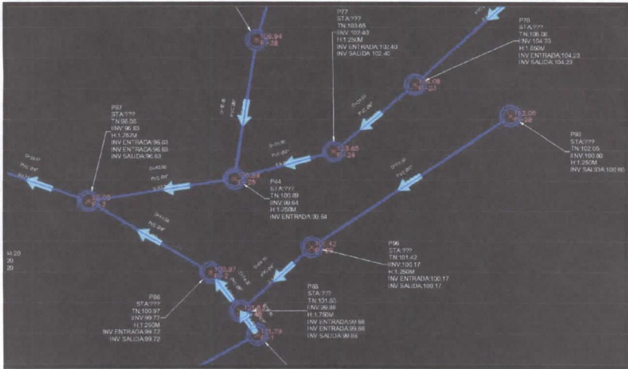
Introducción de datos del diseño en la planta general de la red (invertida, diámetro de tubería, dirección y datos de pozos)
