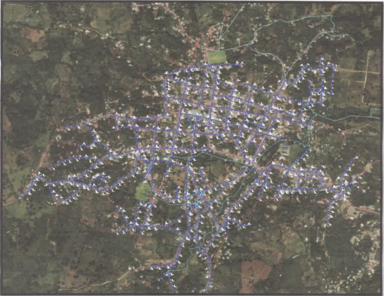
Creación de planta general de red de alcantarillado incluyendo sus datos topográficos (elevación de Terrano natural), y descripciones por cada pozo.
