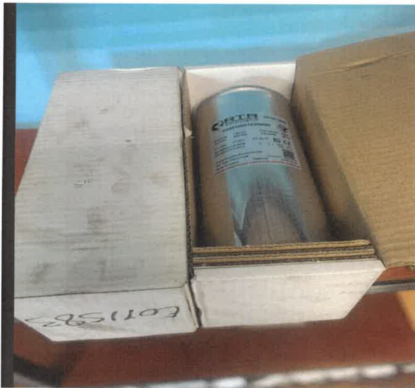
2 CAPACITORES TRIFOSICO 10KVAR
