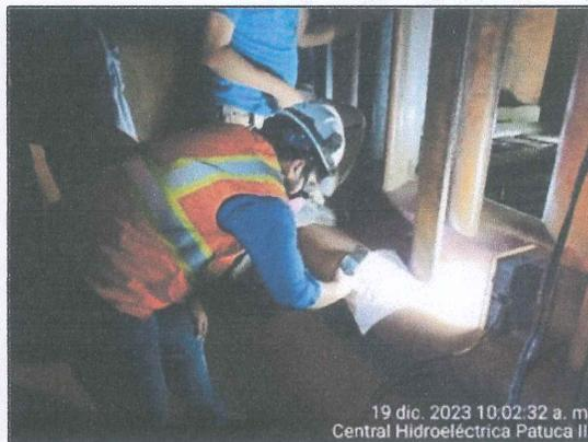
**Pruebas a soldadura con aplicación de tintas penetrantes en los álabes fijos de la unidad No. 2.**
