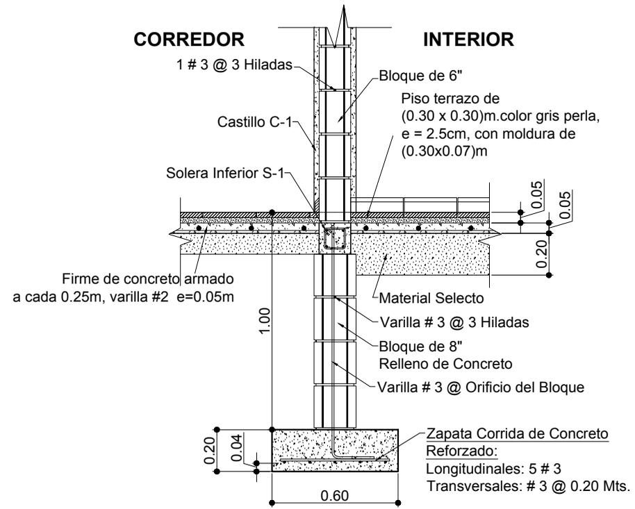
**DETALLE DE ZAPATA CORRIDA BAJO PARED**
