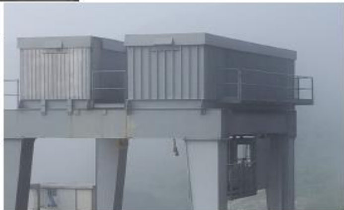
Cabina de Control, Plataforma de acceso y Escaleras (el acceso a la Grúa es por el Contenedor de la maquinaria del Gancho Auxiliar)
