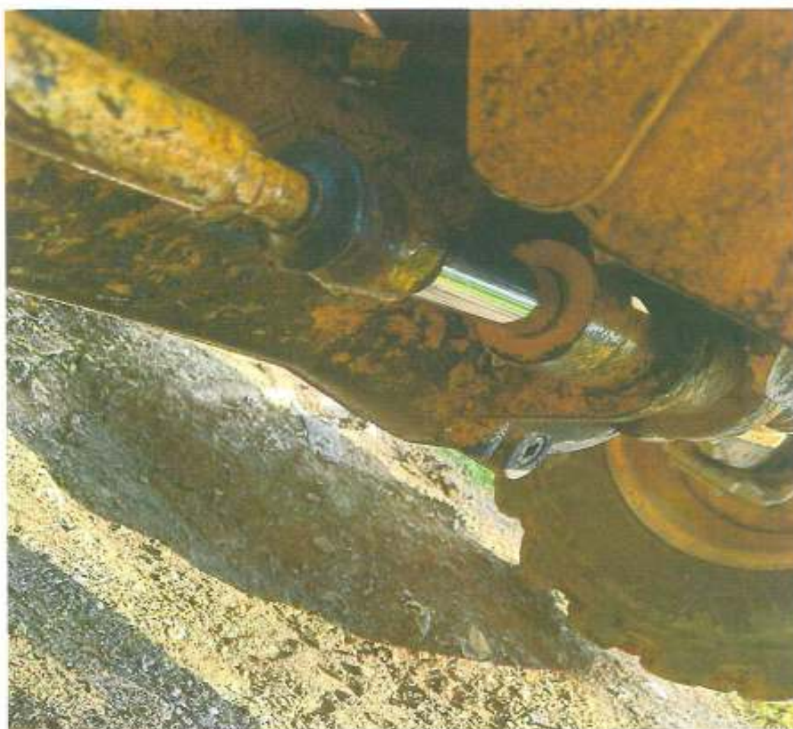
Sistema de giro en la retro excavadora J/D 310L Problemas de retenedores del sistema hidráulico se dañaron y necesitan ser cambiados.
