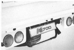
Soporte de la placa trasera y paso: Proporciona una manera conveniente de ampliar su alcance al cargar o descargar elementos.
