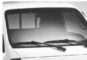
Cristal tintado: Mantiene la temperatura de la cabina a un nivel cómodo cuando se trabaja en climas cálidos.
