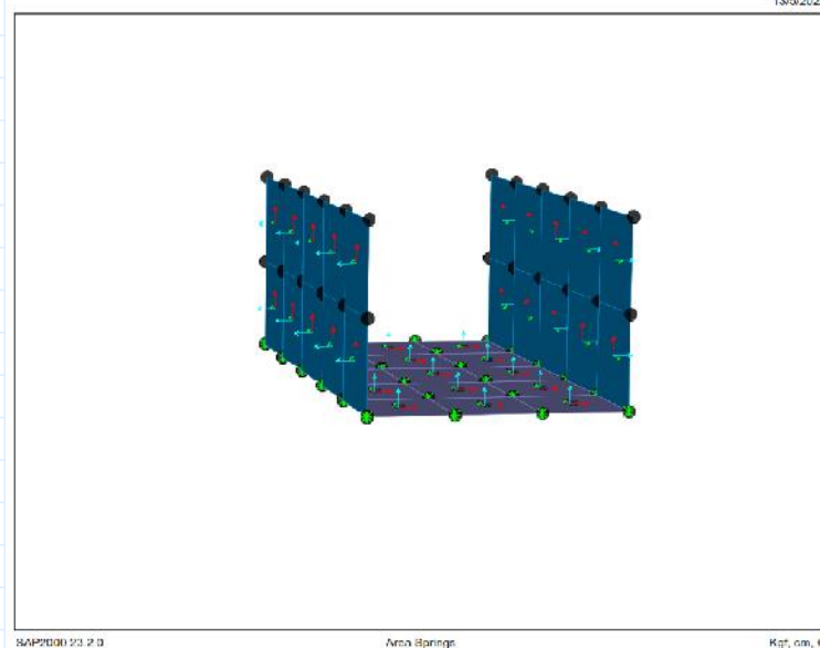
Aplicación restricciones y condiciones de contacto
