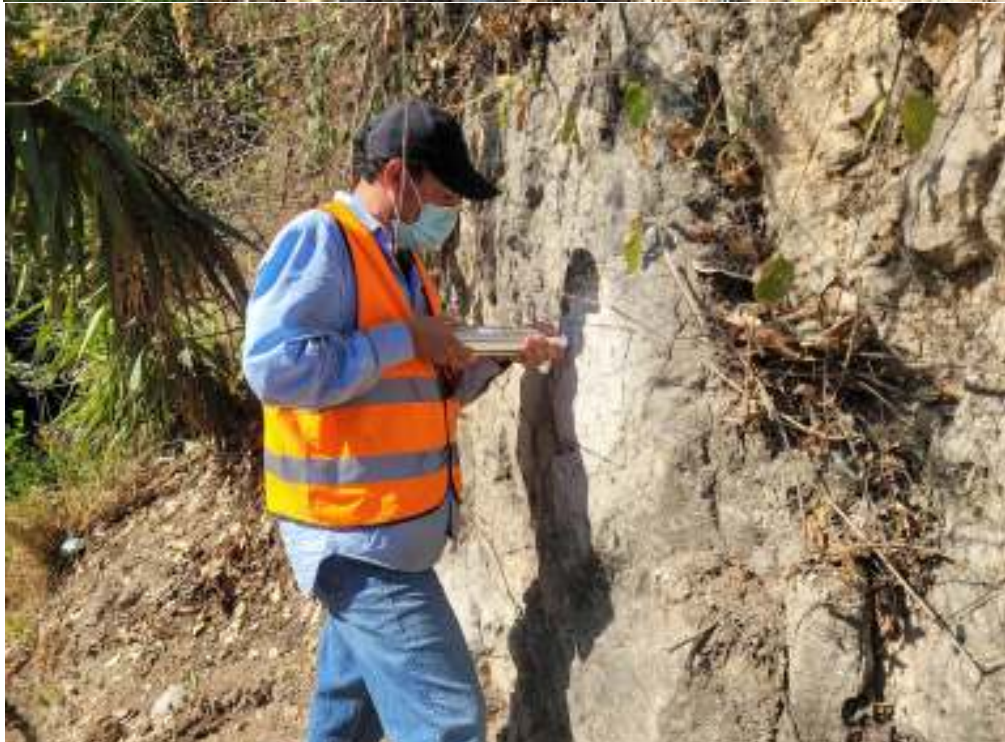
Ilustración 12 Ensayo con martillo de Schmidt.
