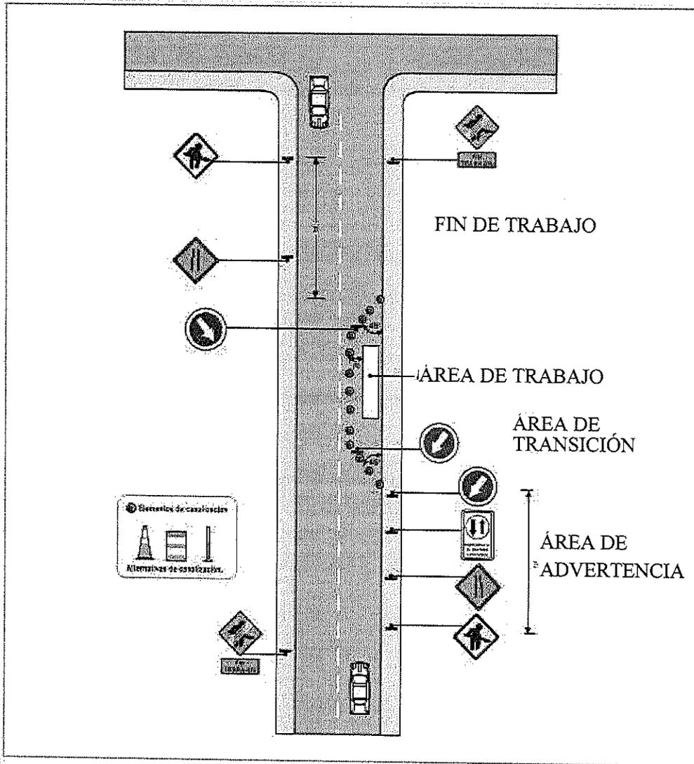
Este esquema se aplica siempre y cuando el flujo bidireccional es menor a 800 vehículos por día, la longitud de seguridad ( $L_s$ ) más la longitud de los trabajos es menor a 75 m y los conductores que se aproximan en ambos sentidos tienen una visibilidad de al menos 100 metros desde el lugar donde se ubica la señal "Trabajos en la Vía".
