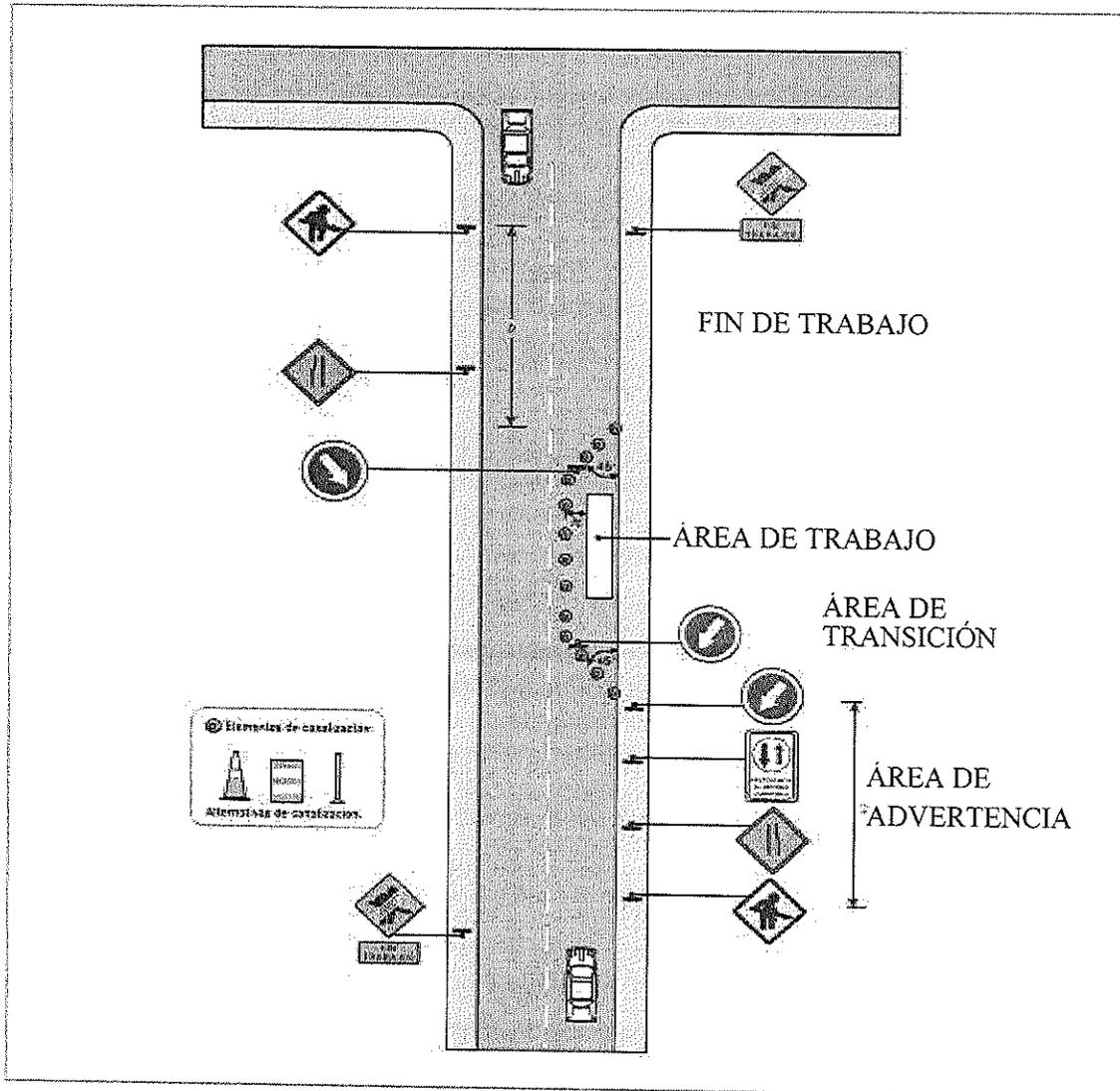
Este esquema se aplica siempre y cuando el flujo bidireccional es menor a 800 vehículos por día, la longitud de seguridad ( $L_s$ ) más la longitud de los trabajos es menor a 75 m y los conductores que se aproximan en ambos sentidos tienen una visibilidad de al menos 100 metros desde el lugar donde se ubica la señal "Trabajos en la Vía".
