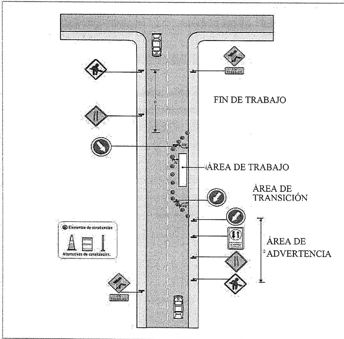
Este esquema se aplica siempre y cuando el flujo bidireccional es menor a 800 vehículos por día, la longitud de seguridad ( $L_s$ ) más la longitud de los trabajos es menor a 75 m y los conductores que se aproximan en ambos sentidos tienen una visibilidad de al menos 100 metros desde el lugar donde se ubica la señal "Trabajos en la Vía".
