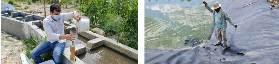
*Figure 23 Extracción de muestras para realizar análisis químico*
