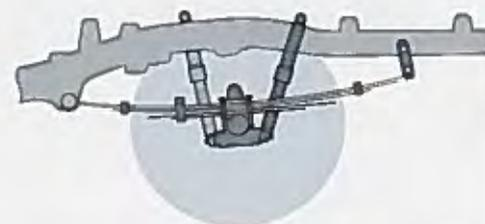
La suspensión trasera es del tipo de eje rígido. La ballestas (resortes de hojas) y la fuerza de amortiguamiento de los amortiguadores de choque están óptimamente coordinadas para ofrecer estabilidad, control y confort de marcha suave.
