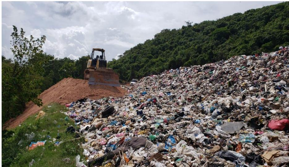
Bulldozer sobre orugas 750J-II en trabajos de soterramiento de basura en relleno sanitario ubicado en el barrio Bella Vista 2
