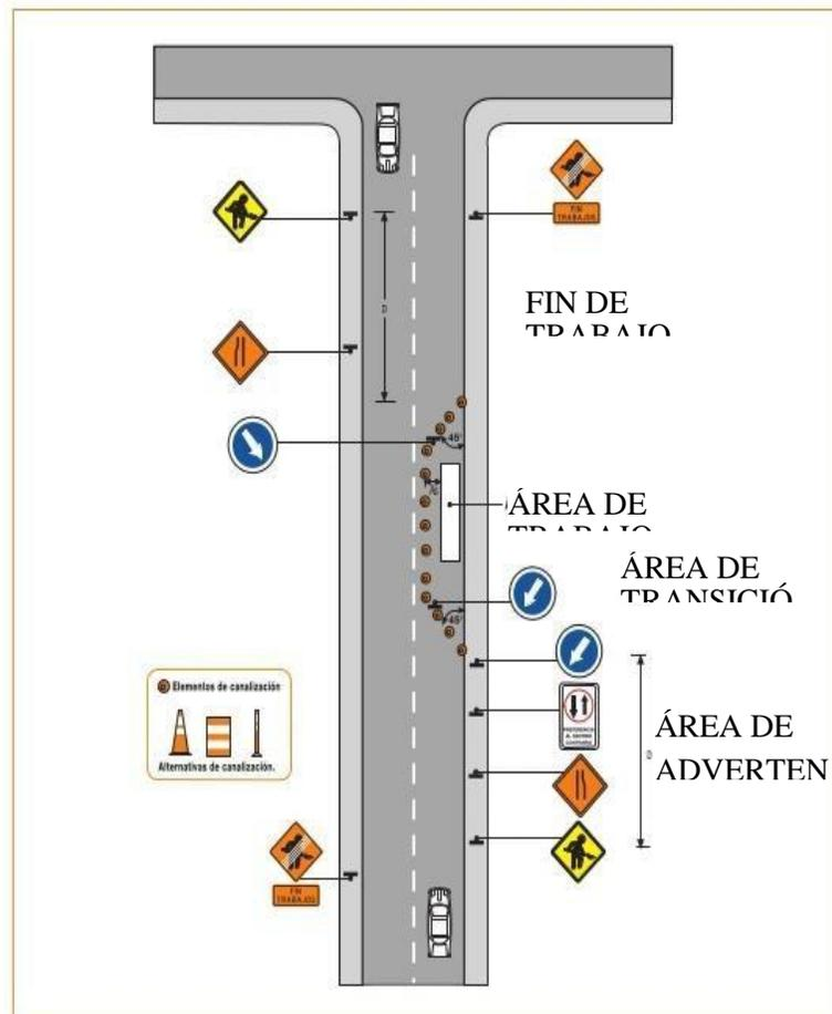
Este esquema se aplica siempre y cuando el flujo bidireccional es menor a 800 vehículos por día, la longitud de seguridad ( $L_s$ ) más la longitud de los trabajos es menor a 75 m y los conductores que se aproximan en ambos sentidos tienen una visibilidad de al menos 100 metros desde el lugar donde se ubica la señal "Trabajos en la Vía".
