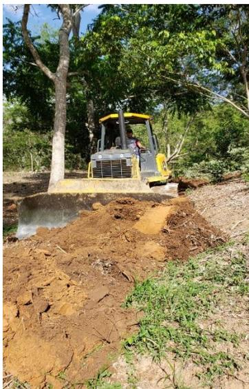
Se aprecia la máquina municipal Bulldozer sobre orugas 750J-II en trabajos de apertura y ampliación de calles en caserío Nueva Ceibita.
