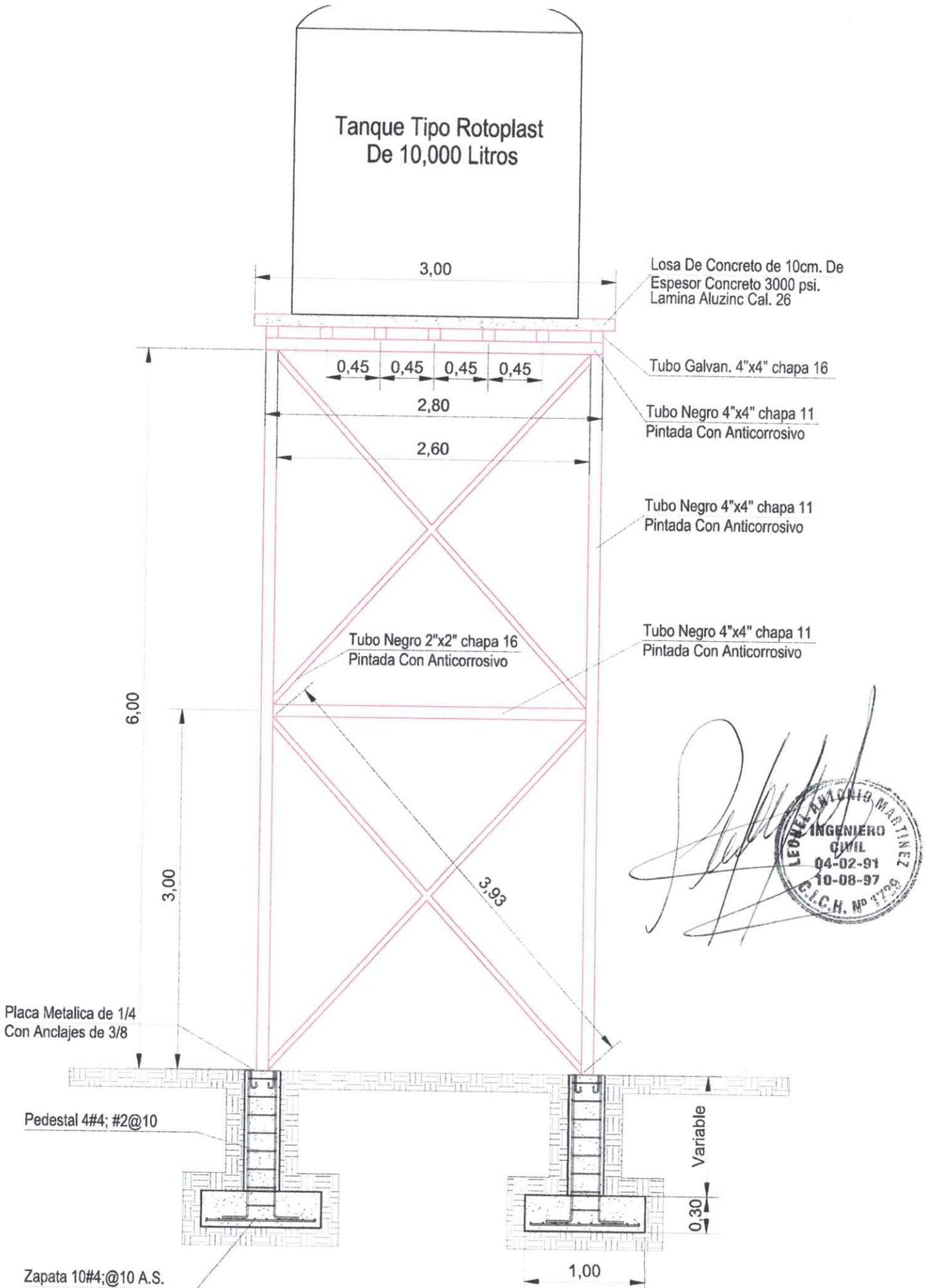
Losa De Concreto de 10cm. De
