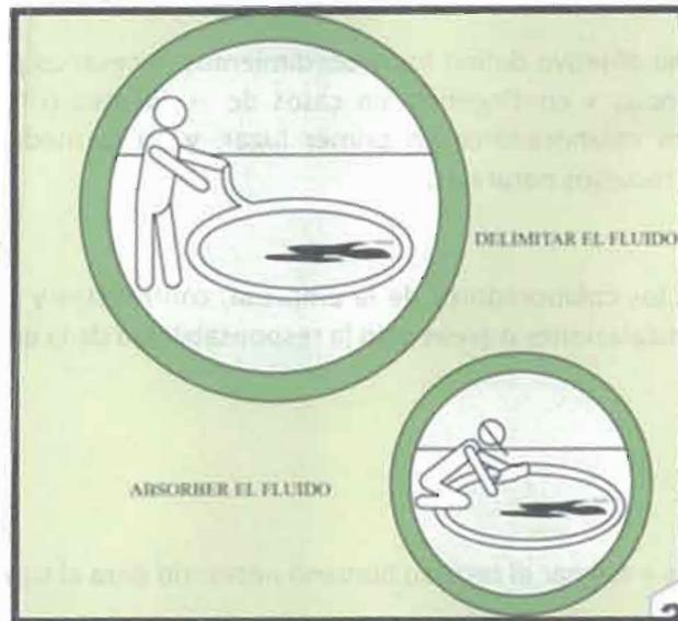
Imagen 3. Pasos para el control del derrame en superficies de concreto
