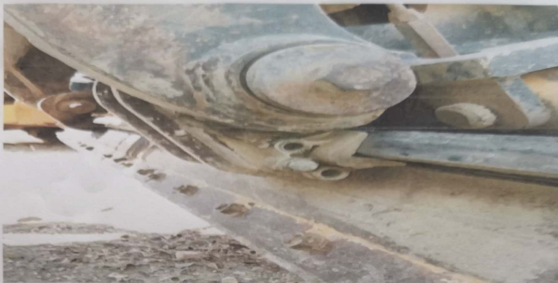
CUCHILLA EN MAL ESTADO DE LA MOTONIVELADORA MUNICIPAL
