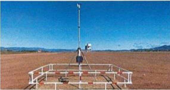
Fig. 12. Estación meteorológica automática portátil
