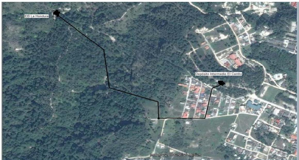
Esta línea de aducción por bombeo transporta el agua cruda proveniente de la fuente superficial Río Higuito hasta el depósito intermedio Los Plancitos por medio de tres estaciones de bombeo mencionadas anteriormente. La línea de aducción tiene una longitud total de aproximadamente 6,350 metros lineales, es de hierro fundido dúctil (HFD) de 300 mm (12 pulgadas) de diámetro y con un desnivel geométrico de 705.44 metros
