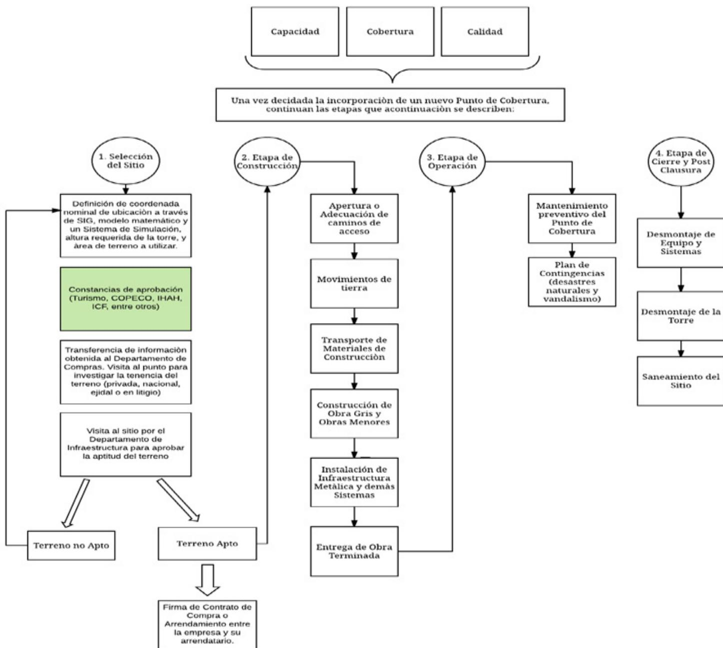
Figura 1. Proceso de Apertura de un Nuevo Punto de Cobertura
