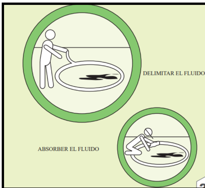
Imagen 10. Pasos para el control de derrame en superficies de concreto
