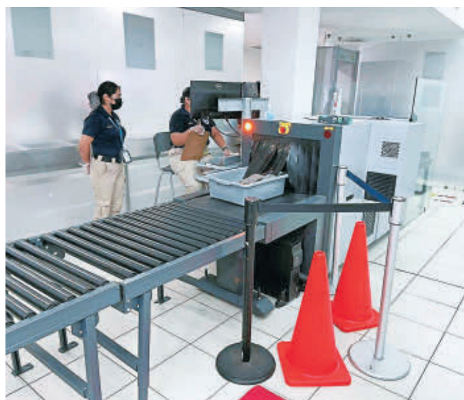
TECNOLOGÍA. El personal del Departamento de Seguridad Aeroportuaria revisa el equipaje de una persona con una máquina de rayos X.
