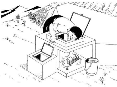
Limpieza y desinfección caja de captación
