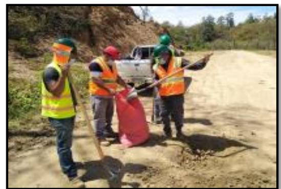
*Ilustración 4: Extracción de material de suelo para análisis a través de calicatas*
